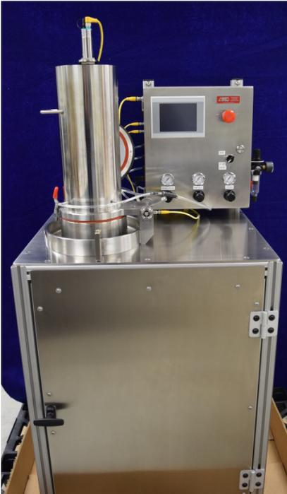
O Formador de Folhas modelo TAPPI, semiautomático, com sistema de drenagem produz folhas manuais de forma rápida e constante. O módulo de controle regula o tempo de enchimento, agitação, repouso e drenagem. A folha formada neste formador é prensada automaticamente para reduzir a fadiga do operador e aumentar a consistência. Como opcional temos o sistema de água branca para estudo de finos e produtos químicos conforme normas internacionais como TAPPI T-205 & T-219, ISO 5269/1, CPPA C.4 & C.5
